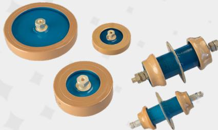
Condensatori ceramici ad alta tensione
